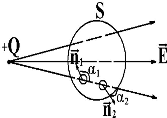
Из рис. 4.10 видно, что каждая силовая линия пронизывает поверхность  $S$  дважды: один раз она входит в поверхность, второй раз – выходит из нее.
