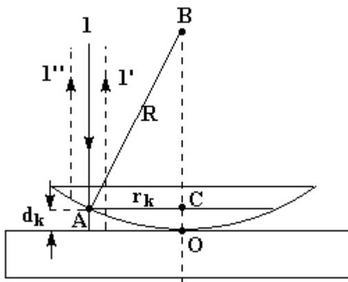
Плосковыпуклая линза с большим радиусом кривизны прижата к плоскопараллельной пластинке в точке **O**. Роль тонкой пленки переменной толщины играет воздух или жидкость, находящиеся между линзой и пластинкой.
