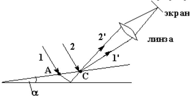
Тонкий клин с углом  $\alpha$  освещается параллельным пучком лучей с длиной волны  $\lambda$ . Луч **1** отражается от нижней поверхности, **2** – от верхней. Верхняя и нижняя поверхность клина не параллельны, значит, не параллельны лучи **1'** и **2'**.
