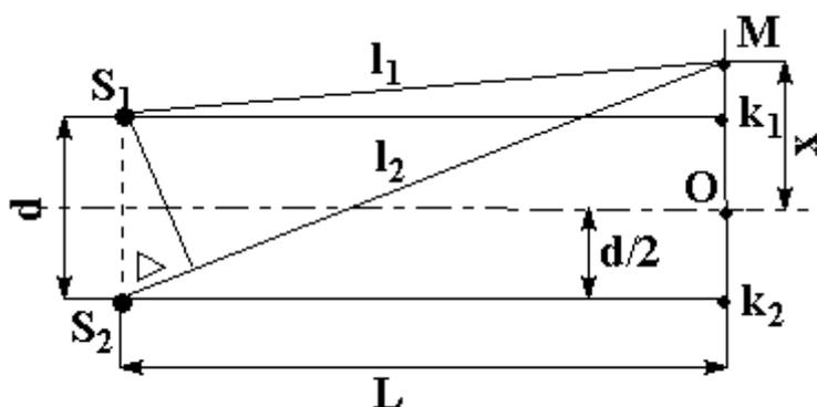
$S_1, S_2$  – два источника монохроматического света, с длиной волны  $\lambda$  (узкие щели).
