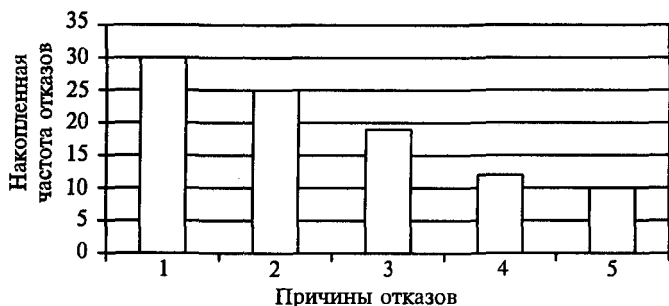
Рис. 9.10. Диаграмма Парето, характеризующая причины отказов коллектора и щеткодержателя:
