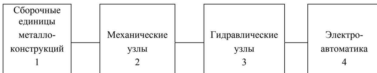
Рис. 7.7. Структурная схема надежности изделия
