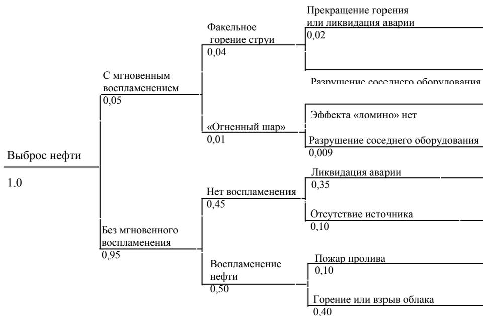
Рис. 10.4. «Дерево событий» аварий на установке первичной переработки нефти
